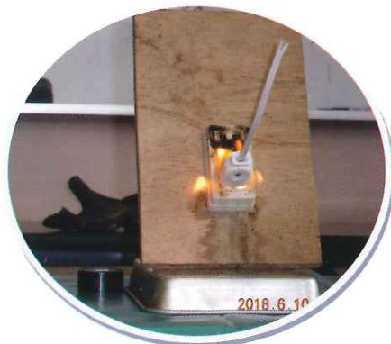
(トラッキング現象)
